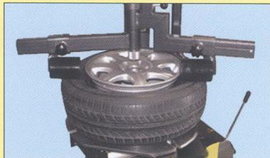
片方のビードローラーでリムを押さえたまま、ターンテーブルを回してスムーズにタイヤを装着できます。
