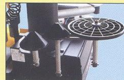
ビードマウントプレスとビードアップローラーは取外して、本体の裏側にあるホルダーに掛ける事ができます。
